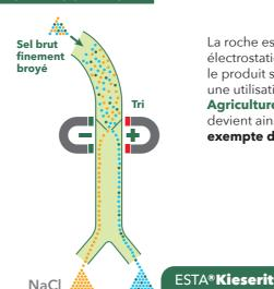
La roche est broyée et notre procédé électrostatique **ESTA®** permet de purifier le produit sans réaction chimique, autorisant une utilisation de notre **kiesérite** en **Agriculture Biologique**. Notre **kiesérite** devient ainsi **ESTA® Kieserit** qui est **pure et exempte de métaux lourds**.
